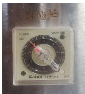
۱. برای تعیین وزن کباب ها، ابتدا دریوش تایمر را بردارید. این تایمر کورس جک افقی را تعیین می کند. برای کباب با وزن ۸۰ گرم عدد پیش فرض ۱ است. شاخص قرمز رنگ روی عدد یک قرار دهید. باید توجه داشت وزن کباب به مایه کباب بستگی دارد. لذا با چند بار تزریق و تغییر درجه تایmer می توان وزن صحیح را بدست آورد. پس از بدست آوردن وزن دلخواه دریوش تایمر را سر جای خود قرار دهید.
