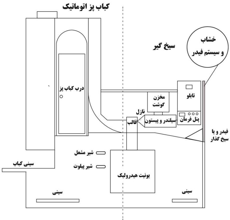
**سیخ گیر:** بار گذاری سیخ بر روی قالب ها و تزریق گوشت بر روی سیخ در قسمت سیخ گیر دستگاه انجام می شود. سیخ گیر شامل یونیت هیدرولیک، پیستون و سیلندر، مخزن گوشت و قالب کباب است. دستگاه بدون سیخ گیر هم می تواند مانند یک کباب پز اتوماتیک کار کند. این ویژگی به دستگاه این امکان داده که بتوان با آن جوجه و دیگر کباب ها را نیز پخت کرد.
